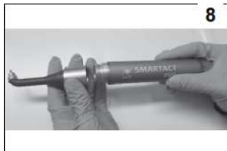
8 Das gebogene Aufnahmeteil mit Ringmutter (Foto 7) an der Oberseite des Zentralkörpers des Handstücks (E) bis zum Anschlag festschrauben.
