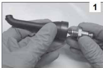
1 Das inertielle System (G) in das gebogene Aufnahmeteil (H) einsetzen
