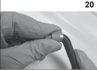
الصورة 20 -| التثبيت الصحيح لحامل الدبوس برأس المقبض يتضح بسماع صوت نقرة!
