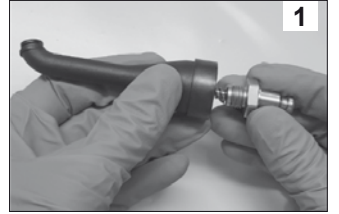
الصورة 1 - قم بإدراج نظام القصور الذاتي (G) داخل الجسم المنحني (H)
