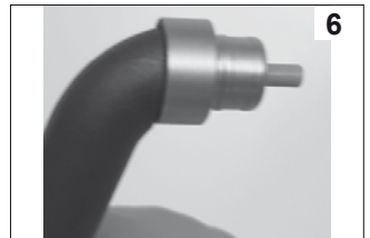
Die Ringmutter am Kopf (samt dem in Foto 5 gezeigten Einweg-Schlagsystem) bis zum Anschlag am Kopf des gebogenen Aufnahmeteils (H), in dem sich der Einweg-Schlagbolzen (M) befindet, festschrauben
