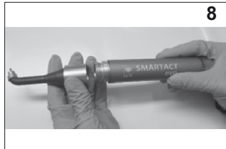
8 Avvitare il corpo curvo con ghiera (Foto 7) sul lato superiore del corpo centrale del manipolo (E), stringendo fino a battuta.
