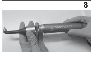
8 Kavıslı gövdeyi sonuna kadar sıkarak ünitenin orta gövdesinin üst tarafı üzerine (E) halka somun (Resim 7) ile vidalayın.
