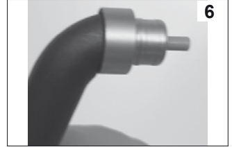
6 헤드 링 너트(일회용 스템 장치 포함, 사진 5 참조)를 일회용 해머(M)가 포함된 커브형 바디(H)의 헤드에 끝까지 돌려서 끼우고 조이십시오
